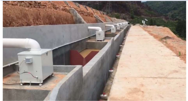
地表径流双翻斗流量计 国家土壤质量福安观测实验站
